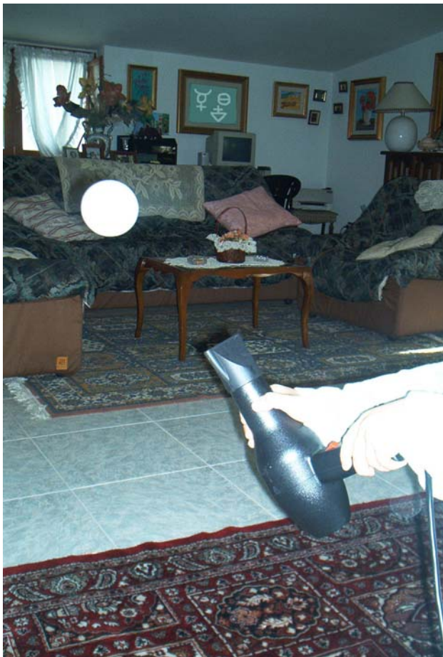
Fig. 9.13 - Pallina di polistirolo in levitazione grazie ai principi fluidodinamica -
