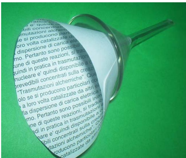
Fig. 7.13 - Semplice esperimento che dimostra il principio di Bernoulli -
