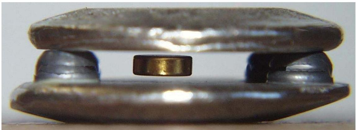
Fig. 19.14 - Magnete al NdFeBo in levitazione fra due blocchi di bismuto -
