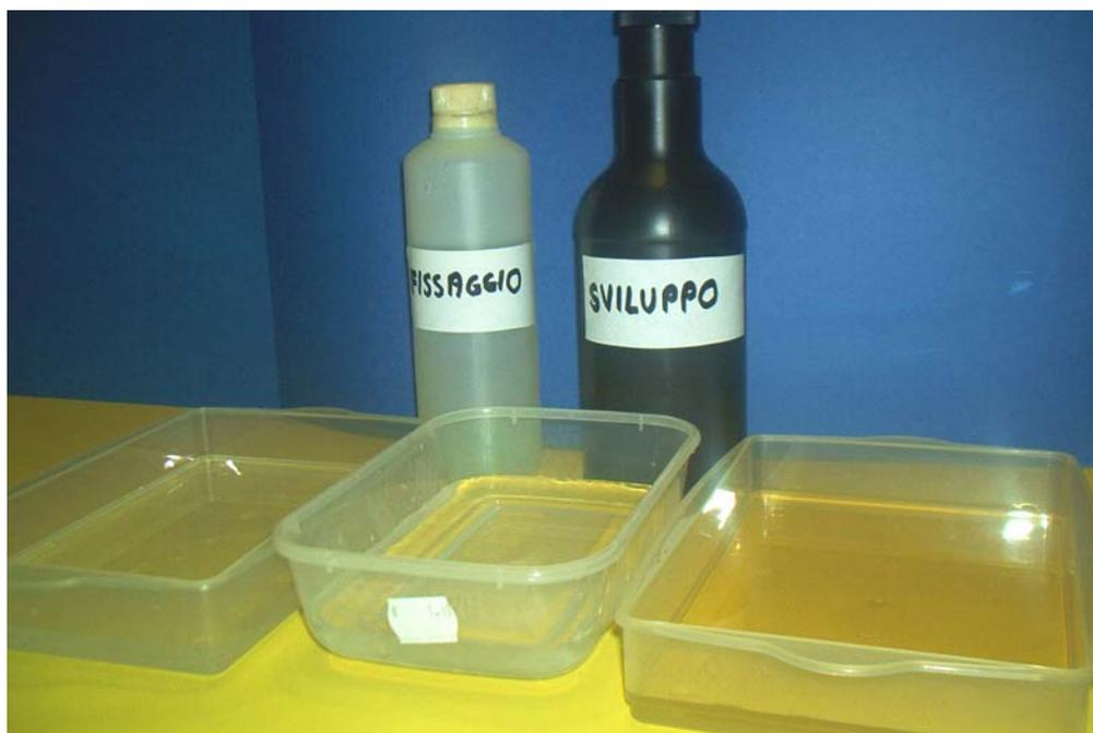
Fig. 1.14.0 - Vaschette e reagenti necessari per il trattamento dei cartoncini fotografici -
