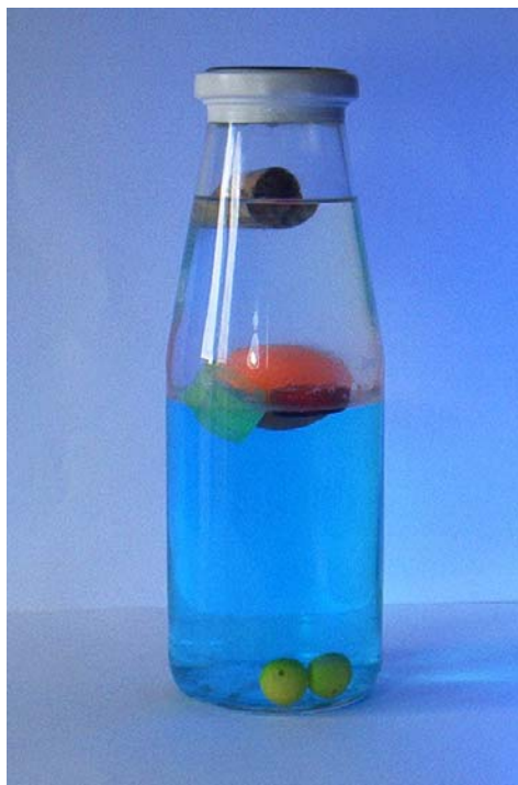
Fig. 1.2 - Separazione di vari materiali sulla base della loro densità -
