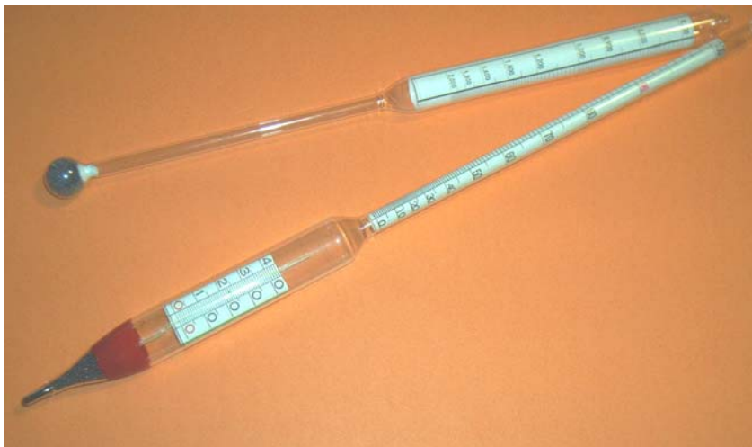
Fig. 4.2 - Alcuni densimetri per liquidi -
