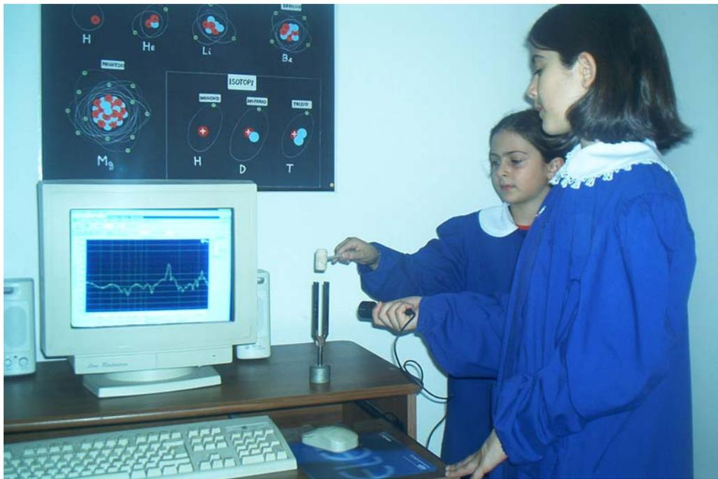
Fig. 11.1.6 - Verifica dello spettro dei suoni effettuati tramite computer -
