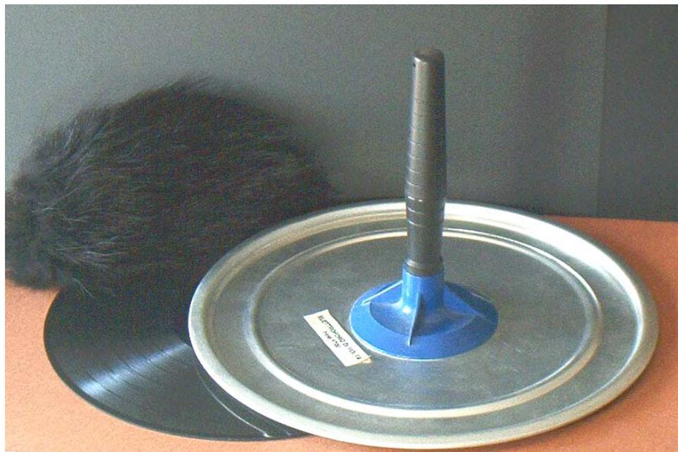
Fig. 12.7 - Elettroforo ottenuto con un disco audio da 33 giri ed un coperchio di alluminio -
