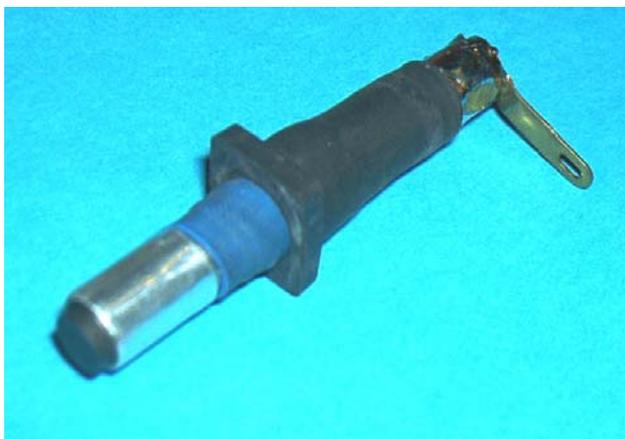
Fig. 24.7 - Connettore autocostruito utilizzabile per il terminale AT della bobina -
