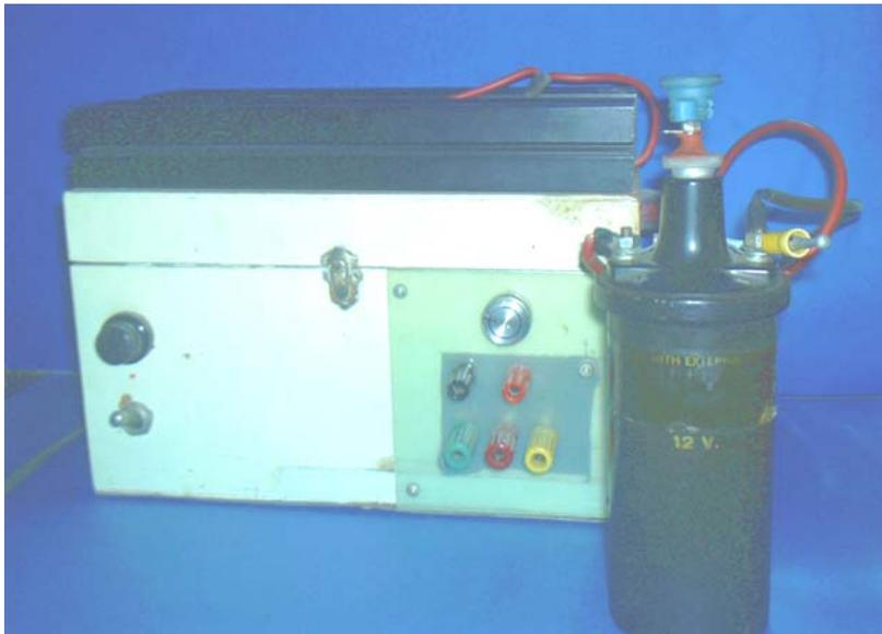
Fig. 23.7 - Prototipo dell'elevatore di tensione per bobina -
