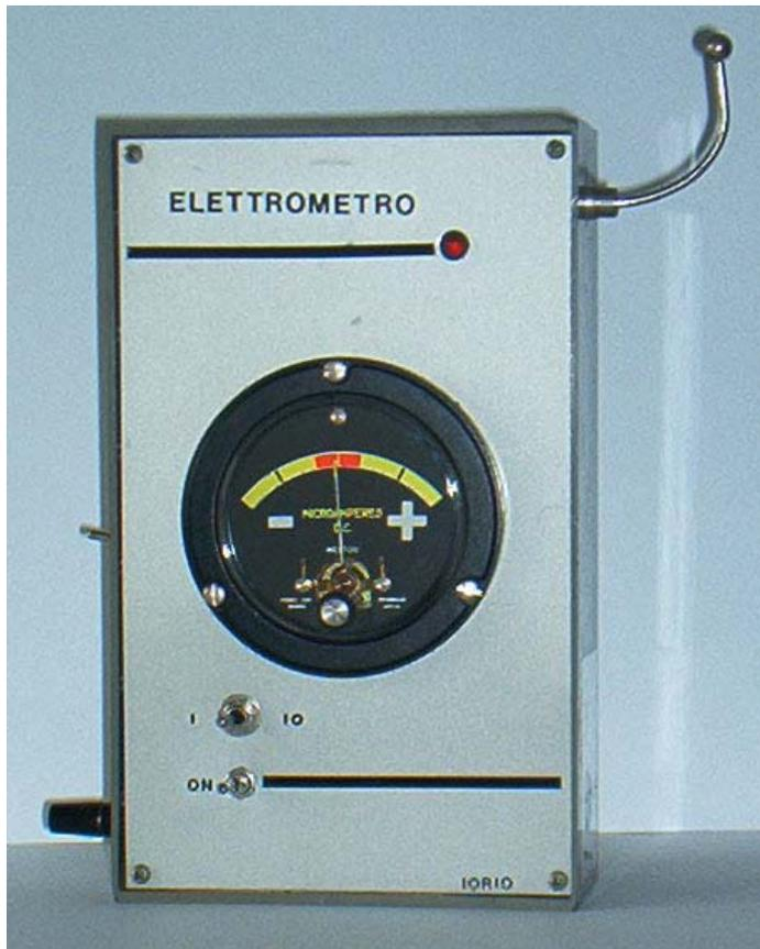
lato negativo della scala. Viceversa se provate a elettrizzare una verga di vetro e avvicinate quest'ultima all'apparecchio, l'indice dello strumentino si dirigerà verso il positivo. Grazie a questo strumento quindi, voi potete non solo rilevare con estrema sensibilità la carica elettrica posseduta dai corpi isolanti che avete elettrizzato, ma potete anche stabilire il segno di questa carica.
