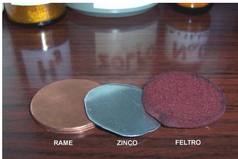
Fig. 3.9 - I materiali da sovrapporre per fare la pila -
