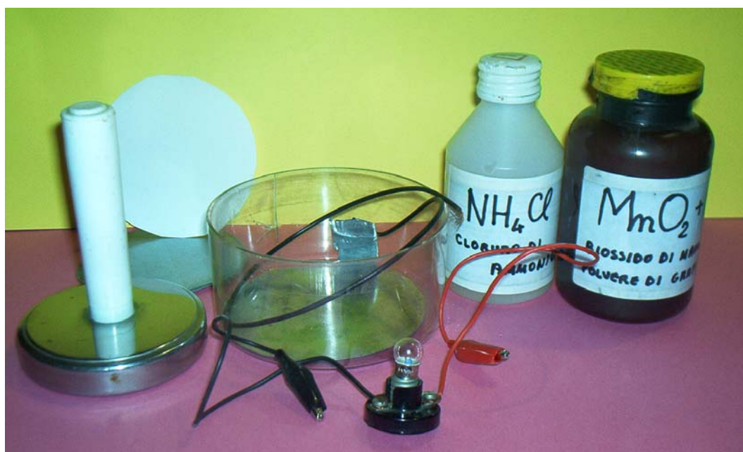
Fig. 5.9 - Kit per realizzare facilmente in aula una pila Leclanchè -
